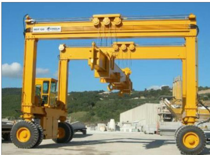
Abbildung 3: Portalhubwagen zum Handling der HGÜ-Kabeltrommeln (beispielhaft)
