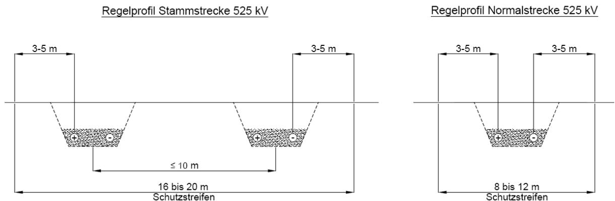
Abbildung 2: Kabelprofil Kabelgraben für Stammstrecke und Normalstrecke
