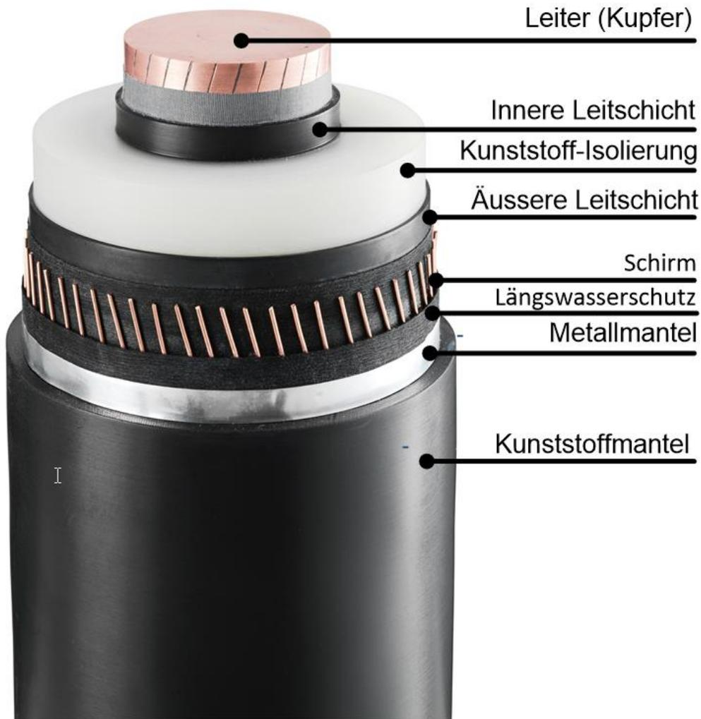
Abbildung 5: Kabelaufbau DC kunststoffisoliertes Erdkabel, beispielhaft mit Kupfer-Leiter
