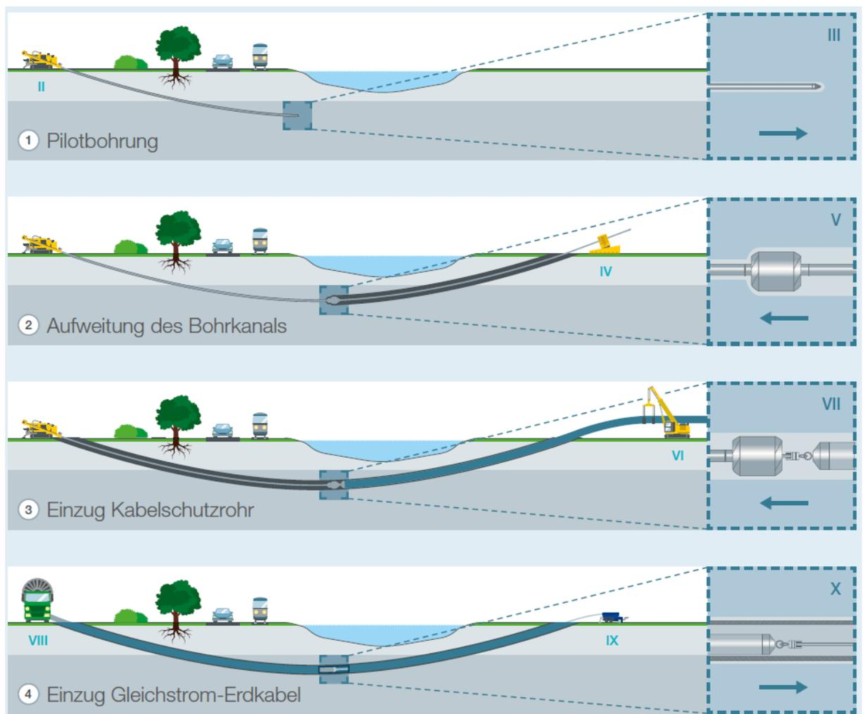
Abbildung 17: Beispiel HDD-Verfahren
