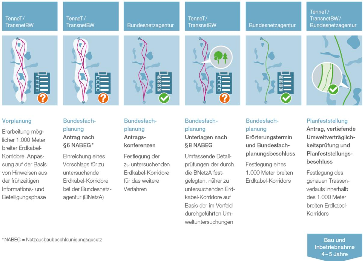
Abbildung 1: Planungsphasen bis zur Realisierung des Gesamtvorhabens
