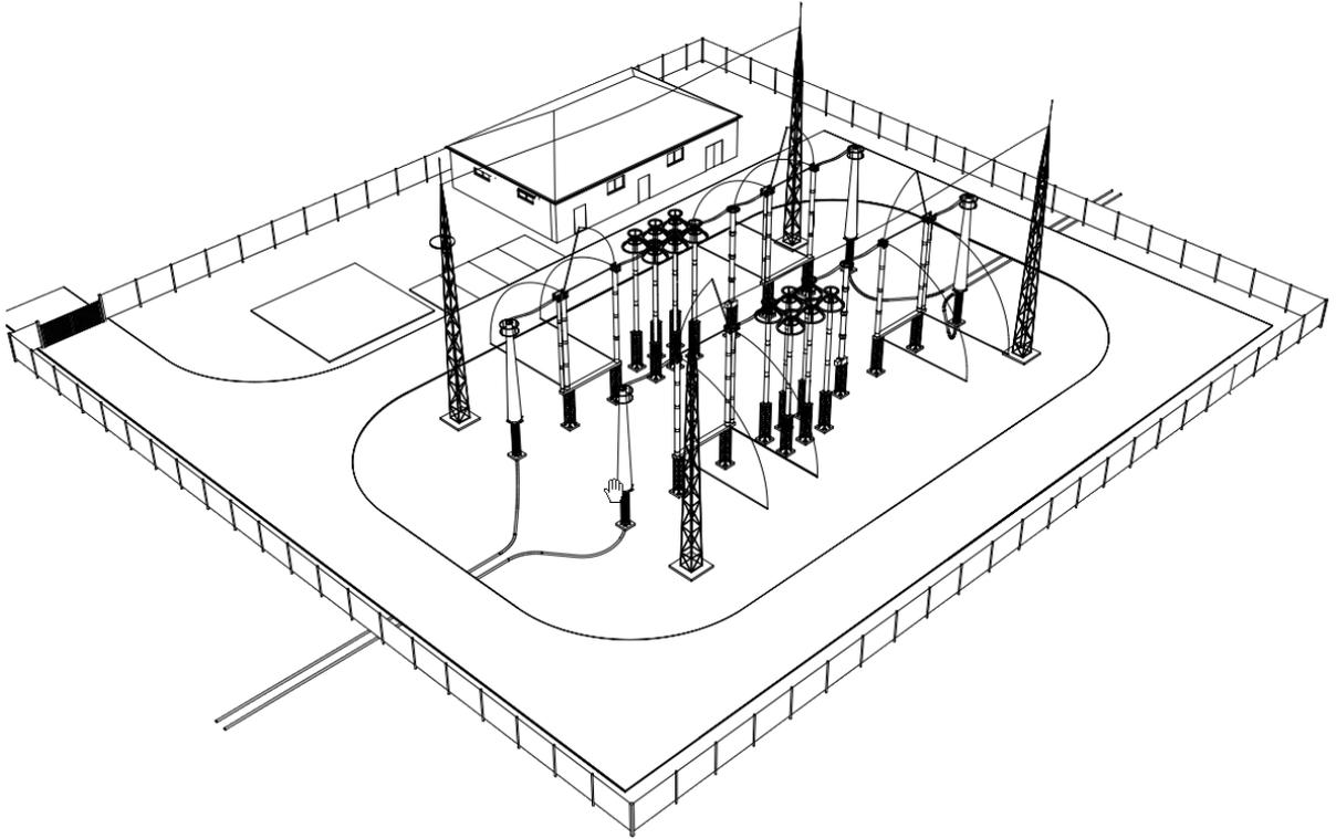
Abbildung 19: Beispiel einer offenen Kabelabschnittstation
