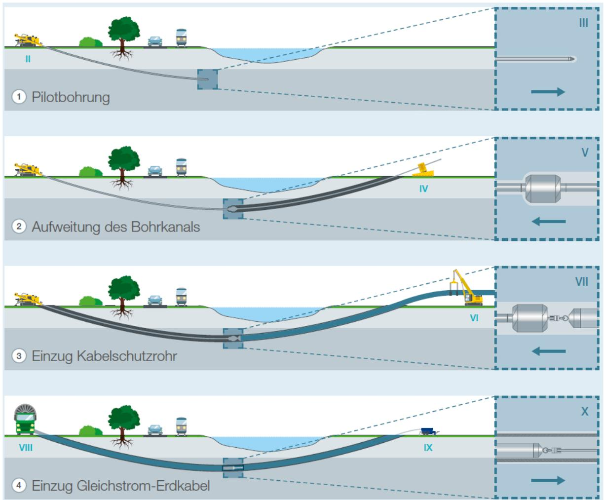
Abbildung 17: Beispiel HDD-Verfahren
