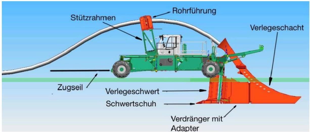
Abbildung 14: Beispielhafte Darstellung des Verlegepfluges (Rohrstrang S-Form)
