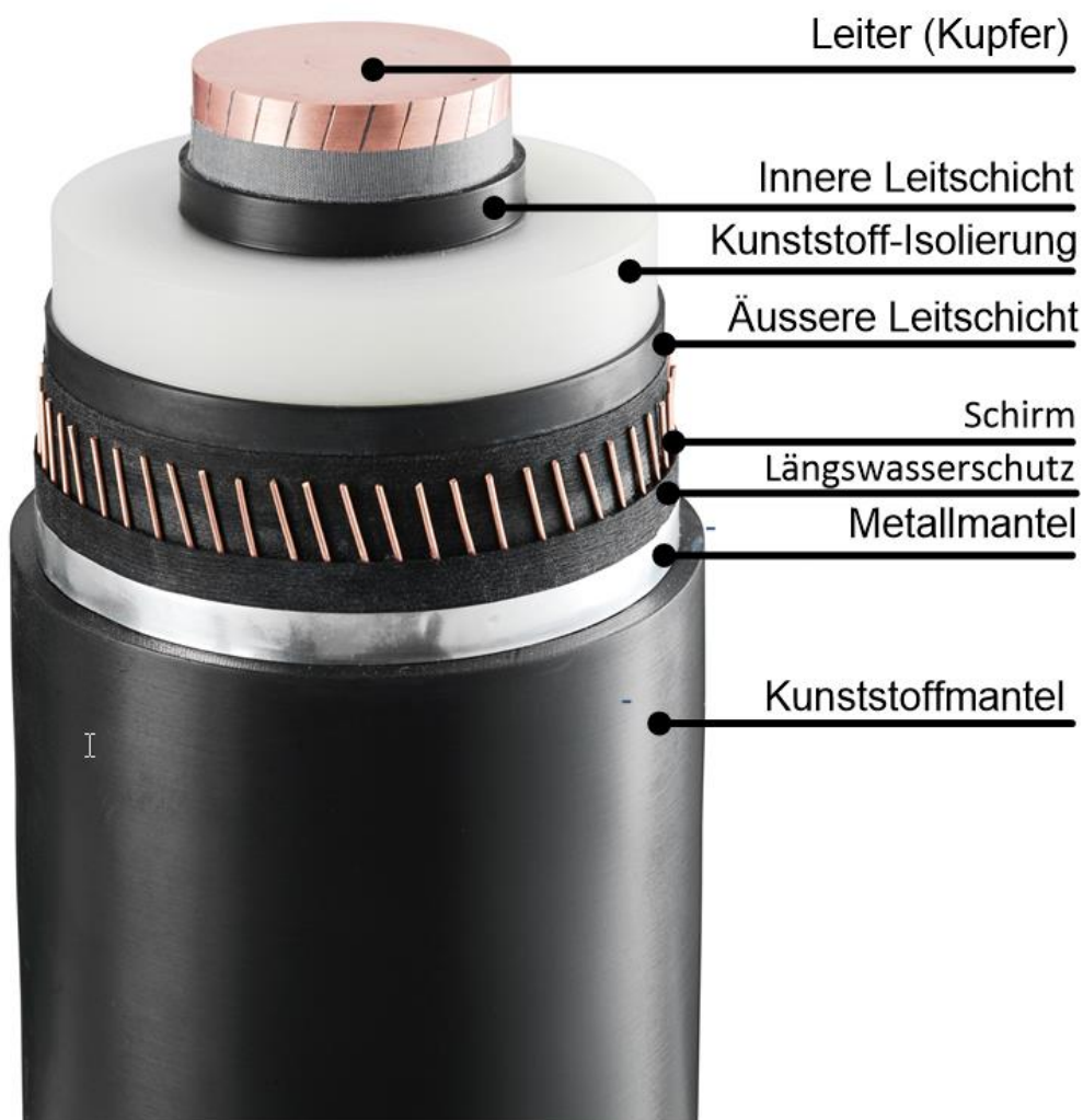
Abbildung 5: Kabelaufbau DC kunststoffisoliertes Erdkabel, beispielhaft mit Kupfer-Leiter
