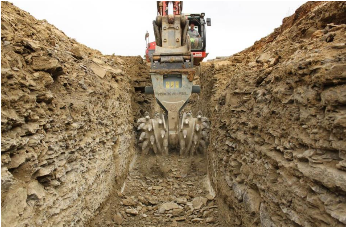
Abb. 2-7: Anbaufräse (Bagger) zur Grabenherstellung (Quelle: www.baumaschinendienst.de ).
