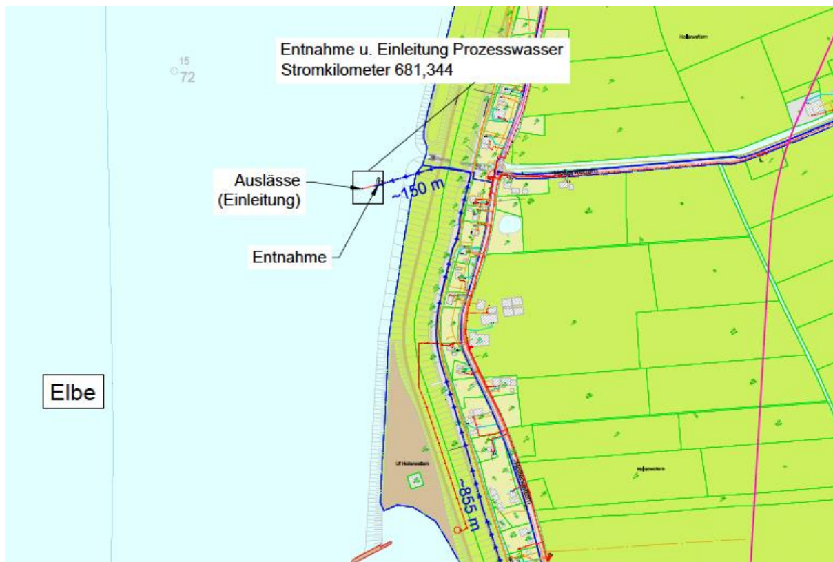
Abb. 3-9: Planausschnitt – Übersichtslageplan Entnahme- und Einleitstelle mit Druckrohrleitungstrasse (blau) in SH (vgl. Anhang Teil F5.9, Lageplan Prozesswasser SH)
