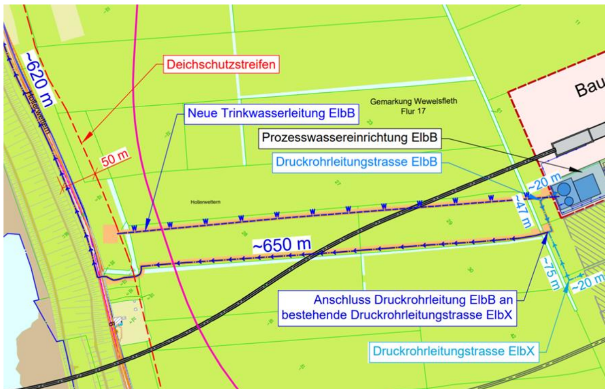
Abb. 3-7: Planausschnitt – Anschluss Druckrohrleitung ElbB an bestehende Druckrohrleitungstrasse ElbX (vgl. Anhang Teil F5.9, Lageplan Prozesswasser SH)
