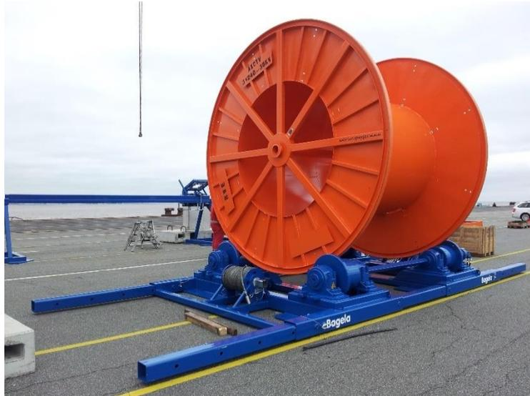
Abb. 23: Trommelbock (beispielhaft Fa. Bagela)
