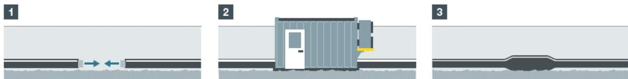
Abb. 5: Schematische Darstellung der Kabelverbindungen (Muffen)
