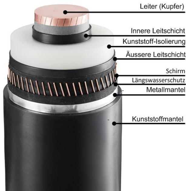
Abb. 1: Kabelaufbau (beispielhaft)
