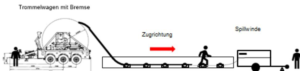
Abb. 18: Verlegung im Kabelgraben (schematischer Aufbau/Graben mit Rollenausbau)
