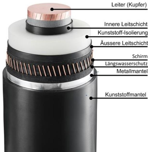
Abb. 4: Kabelaufbau (beispielhaft)
