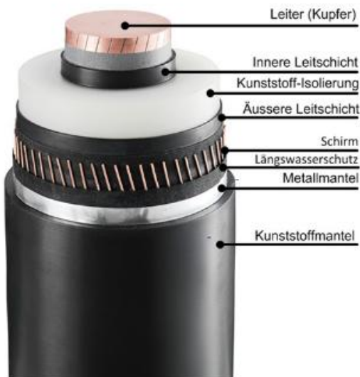
Abbildung 2: Aufbau eines kunststoffisolierten Gleichstrom-Erdkabels (Beispiel) (Quelle: ABB Asea Brown Boveri Ltd zitiert nach 50Hertz Transmission GmbH, Tennet TSO GmbH 2018, S.8)
