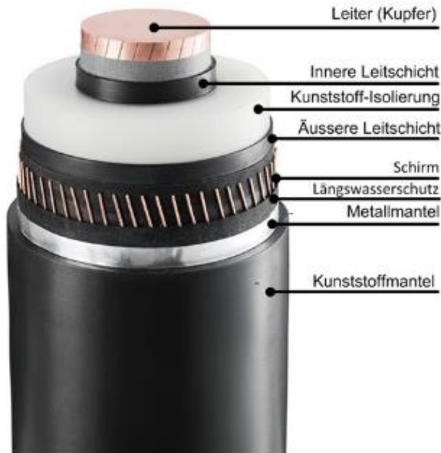
**Abbildung 1: Kabelaufbau (beispielhaft)**
