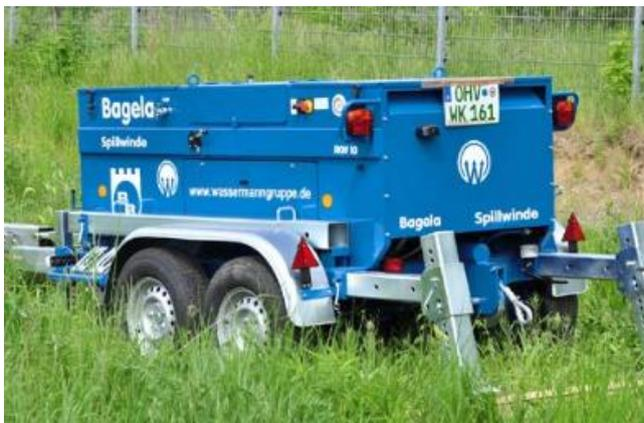
**Abbildung 14: Kabelziehwinde (beispielhaft Fa. Bagela)**
